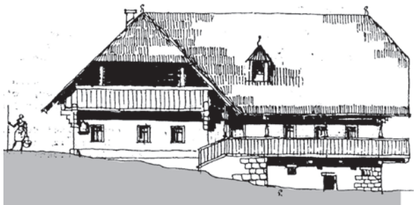
Lesena arhitektura včasih kaže svojo konstrukcijo ali pa je ometana in zaščiten z apnom. Kamniti so seveda temelji in pa zid za pečjo (Janeževa domačija, Strojna na Koroškem, 1986).
