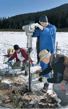
Palinološko vrtanje ekipe Inštituta za arheologijo ZRC SAZU na visokem barju Šiječ. Zaradi naravovarstvenih razlogov je vrtanje potekalo pozimi, ko je bila površina barja pomrznjena in zaščiten s snegom.
